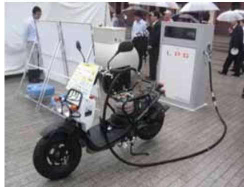
ズーマーLPGとディスペンサー ( 帝都産業(株) トキコテクノ(株) )
